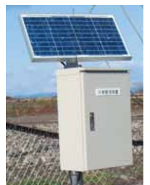
ソーラ電源+ PHS通信の水質計
